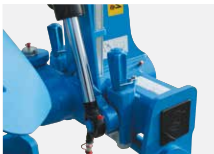
Podešavanje pluga u vertikalnoj ravni
