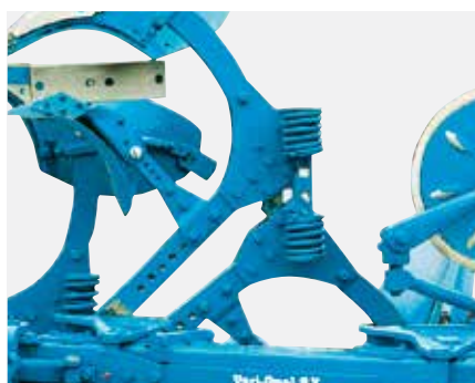
Mehanički sistem za zaštitu od preopterećenja
